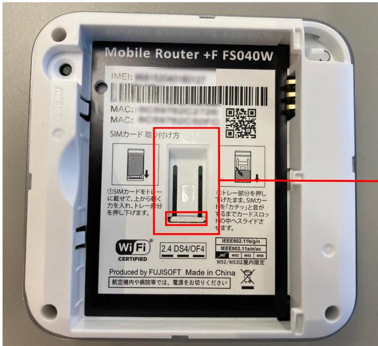
SIMカードをトレーの上に載せ、トレーを押しなが
